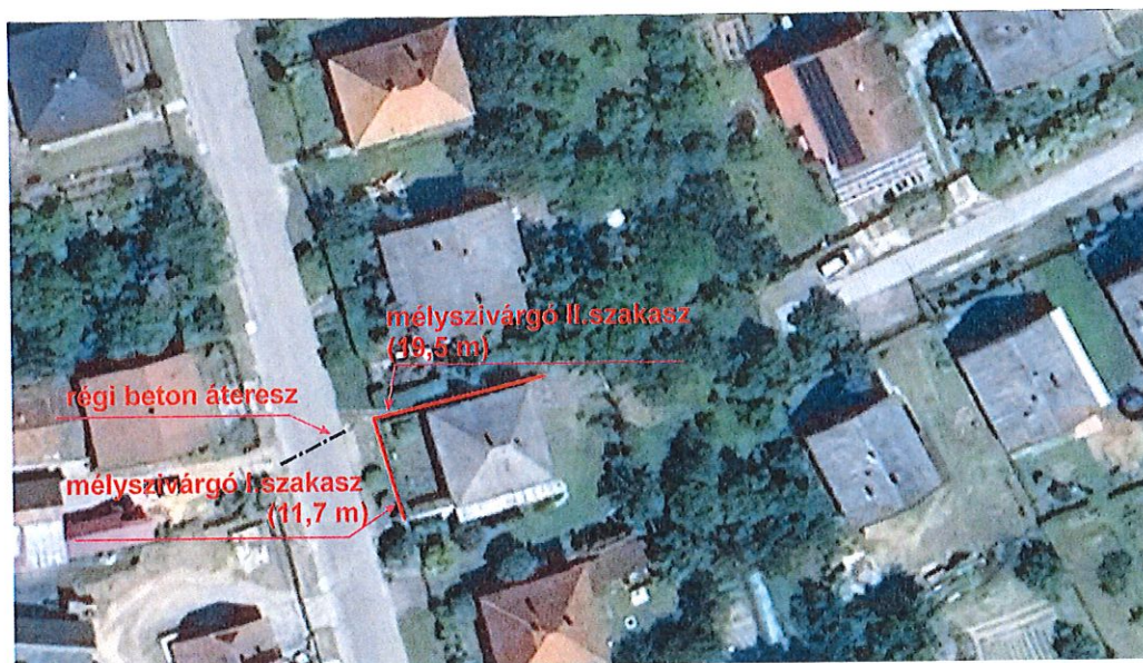
1. ábra: Tervezett szivárgó helyszínrajza
